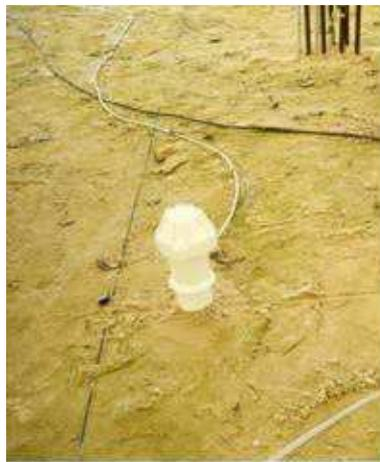
i) Tube d'accès de sonde capacitive
