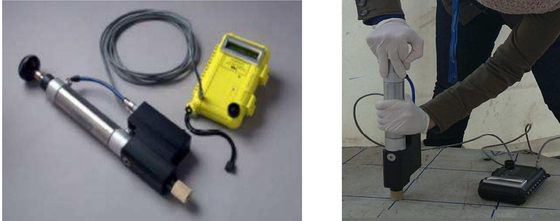
Figure 2. 31 : TinyPerm, appareil de mesure de perméabilité locale
