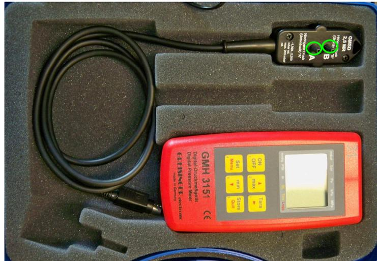
Figure 2. 17 : Capteur de pression différentielle d'air Greisinger
