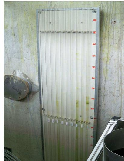
Figure 2. 24 : Tubes piézométriques
